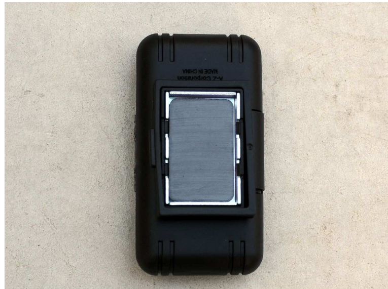
図 2. 閉じた状態。開けるにはマグネットを囲む黒い枠((図 1)で、左に開いている。)を持ち上げるようにして開く。
